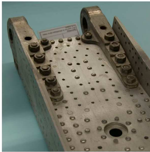
Wing spar connection lug
