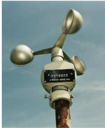
Fig. 4.1: Anemometer
