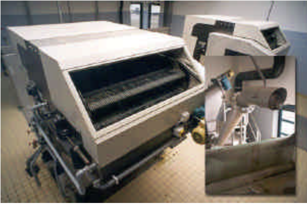
Figuur 6 - Grofvuilverwijdering m.b.v. rooster
