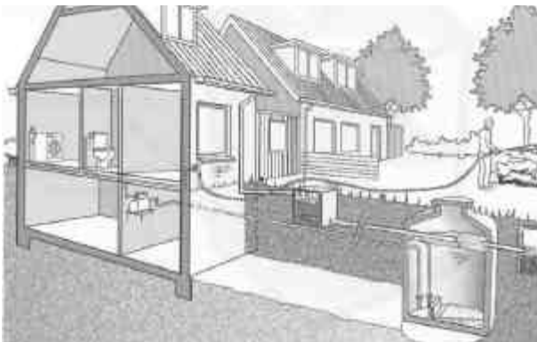
Figuur 1 - Schematische weergave van binnen- en buitenriolering
