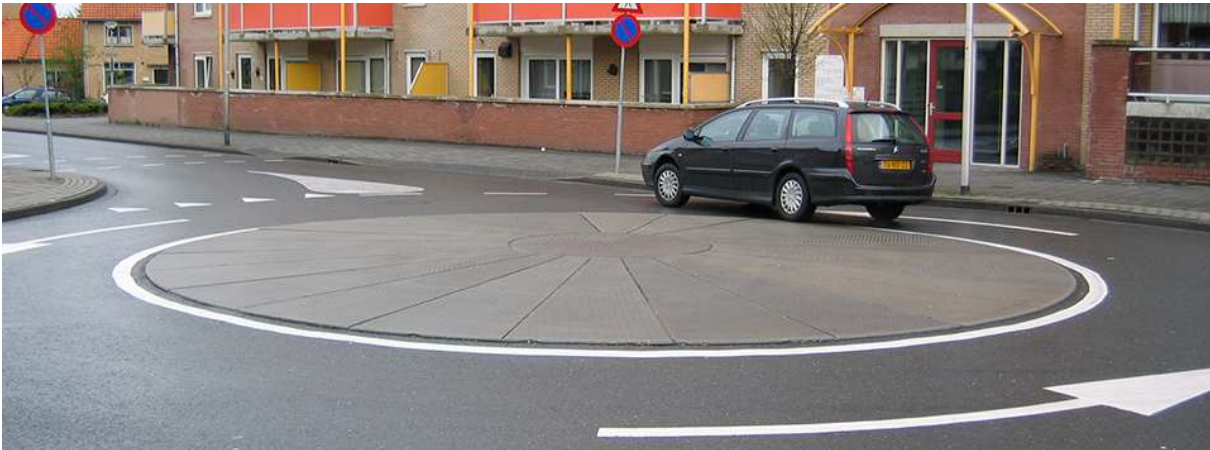
FIGUUR 3.31: MINI-ROTONDE MET OVERRIJDBAAR MIDDENEILAND
