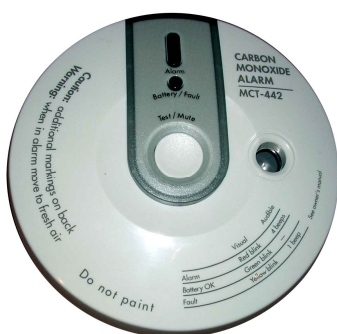
Tegenwoordig worden meestal koolstofmono-oxide detectors gebruikt die een alarmsignaal afgeven in de vorm van geluid.
