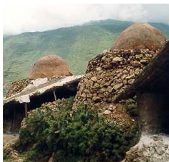
In China wordt nog ongebluste kalk gemaakt in deze koepelvormige ovens.
