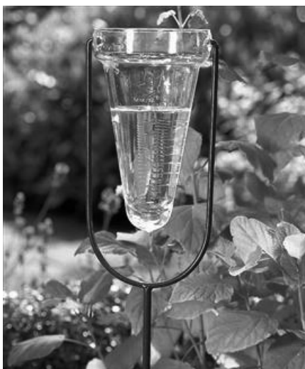
Figuur 5.9 - Niet registrerende regenmeter
