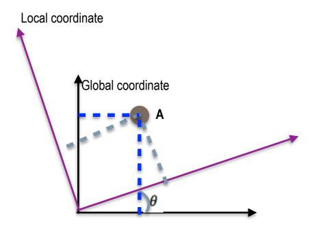
$$\begin{bmatrix} u_A \\ u_B \end{bmatrix} = \begin{bmatrix} \cos\theta & \sin\theta \\ -\sin\theta & \cos\theta \end{bmatrix} \begin{bmatrix} U_A \\ U_B \end{bmatrix}$$
