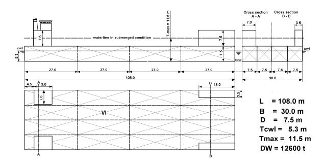
Figure 0.1: Float-On Float-Off Pontoon
