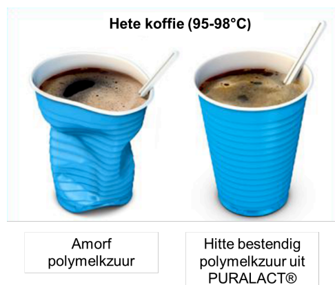
Figuur 2.8: Polymelkzuur heeft een T_m van onder de 100 graden celcius, zodat het voor koffiebekertjes ongeschikt is. Door de ketens te verlengen en zijgroepen te geven, stijgt de T_m .
