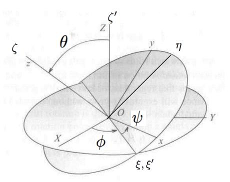
$$\begin{pmatrix} x \\ y \\ z \end{pmatrix} = \begin{bmatrix} \cos \psi & \sin \psi & 0 \\ -\sin \psi & \cos \psi & 0 \\ 0 & 0 & 1 \end{bmatrix} \begin{bmatrix} 1 & 0 & 0 \\ 0 & \cos \theta & \sin \theta \\ 0 & -\sin \theta & \cos \theta \end{bmatrix} \begin{bmatrix} \cos \phi & \sin \phi & 0 \\ -\sin \phi & \cos \phi & 0 \\ 0 & 0 & 1 \end{bmatrix} \begin{pmatrix} X \\ Y \\ Z \end{pmatrix}$$
